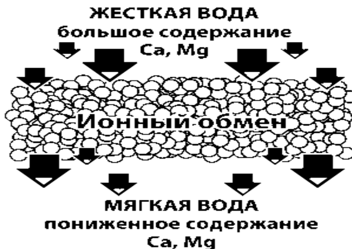
Рис.1.Схема умягчения (снижения солей кальция и магния) методом ионного обмена
