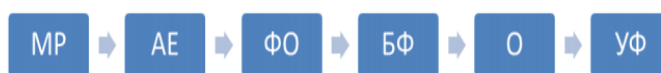
Рис.1. Технологическая схема очистки бытовых сточных вод: МР – механическая решетка, АЕ- аккумулярующая емкость, О – вертикальный отстойник, БФ – биофильтр, О – вторичный отстойник, УФ – блок обеззараживания УФ.
