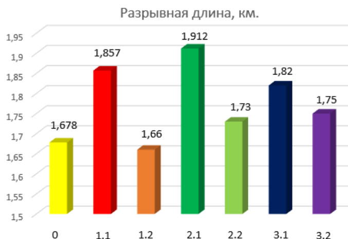
Рис 3. Изменение механической прочности в зависимости от концентрации и от наполнителей (Арбоцелл и МКЦ).
