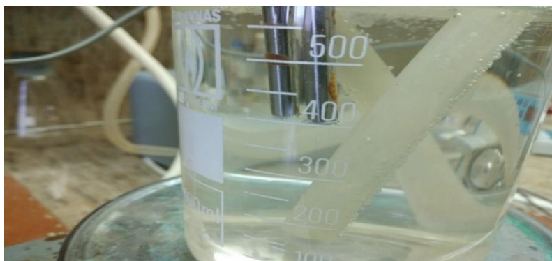
Рис. 1 – С композицией Mg-НТФ (20 мг/дм 3 ). Коррозия электродов. Температура 70°C. Время экспозиции – 3 ч.
