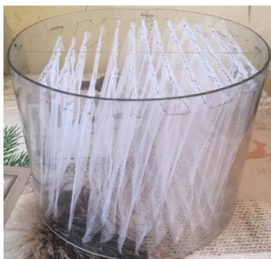
Рис. 3–Блок сетчатой регулярной насадки; вид сбоку, вид сверху
