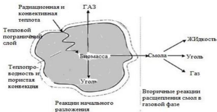
Рис. 1 – Схема пиролиза биомассы
