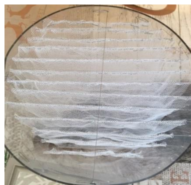
Рис. 3–Блок сетчатой регулярной насадки; вид сбоку, вид сверху
