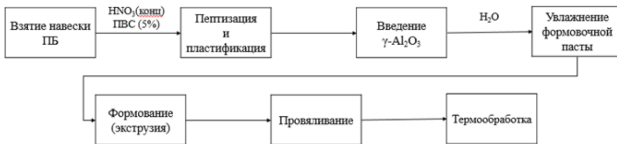
Рис. 1 – Схема синтеза АОН с полимодальной пористой структурой
