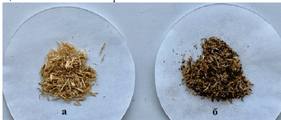
Рис. 2. Образцы древесины, пораженные трутовым грибом ( Inonotus obliquus ): а – «светлая» древесина; б – «темная» древесина
