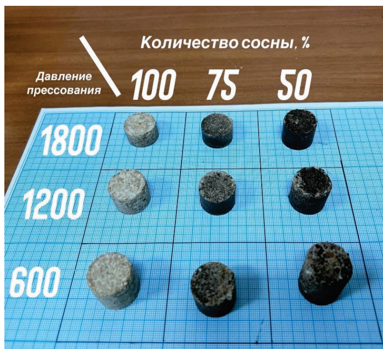
Рис. 3. Полученные брикеты из сосны и лигнина (давление прессования в кг/см 2 )
