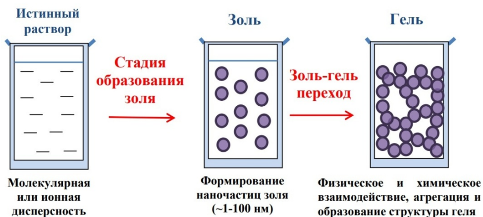
Рис.1. Основа золь-гель метода — схема перехода истинного раствора в золь и далее в гель
