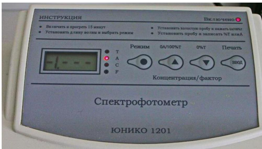
Рис. 8. Вид панели управления спектрофотометра «Unico»
