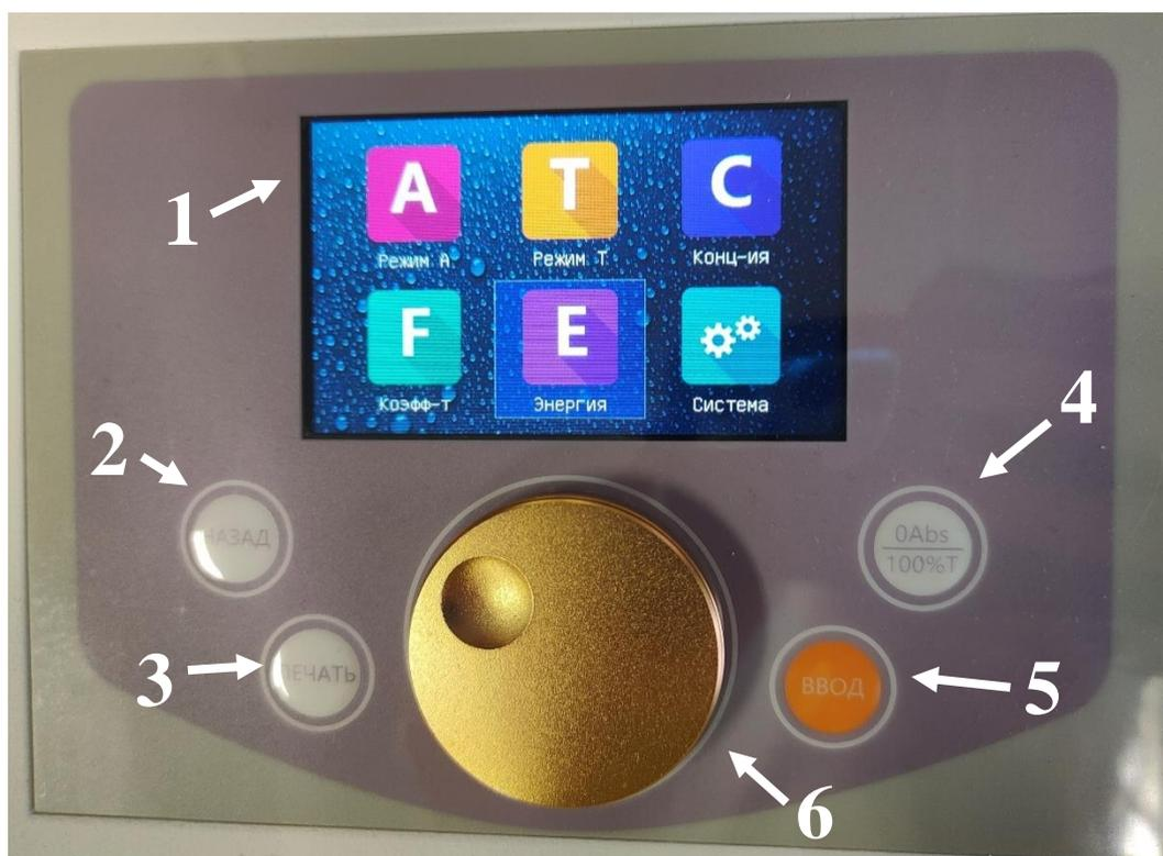
Рис. 11. Панель управления: 1 – основное меню; 2 – кнопка НАЗАД: переводит пользователя в Основное меню; 3 – кнопка ПЕЧАТЬ: в режимах А, Т и С осуществляет отправку на принтер результатов, отображающихся на индикаторе; 4 – кнопка 0А/100%Т устанавливает 100%Т, или 0,000А, когда в отделении для проб находится раствор сравнения; 5 – кнопка ВВОД: служит для подтверждения установленных параметров; 6 – джойстик управления
