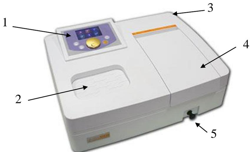
Рис. 10. Общий вид спектрофотометра В-1100: 1 – панель управления; 2 – подставка для кювет; 3 – корпус; 4 – крышка кюветного отделения; 5 – ручка кюветодержателя
