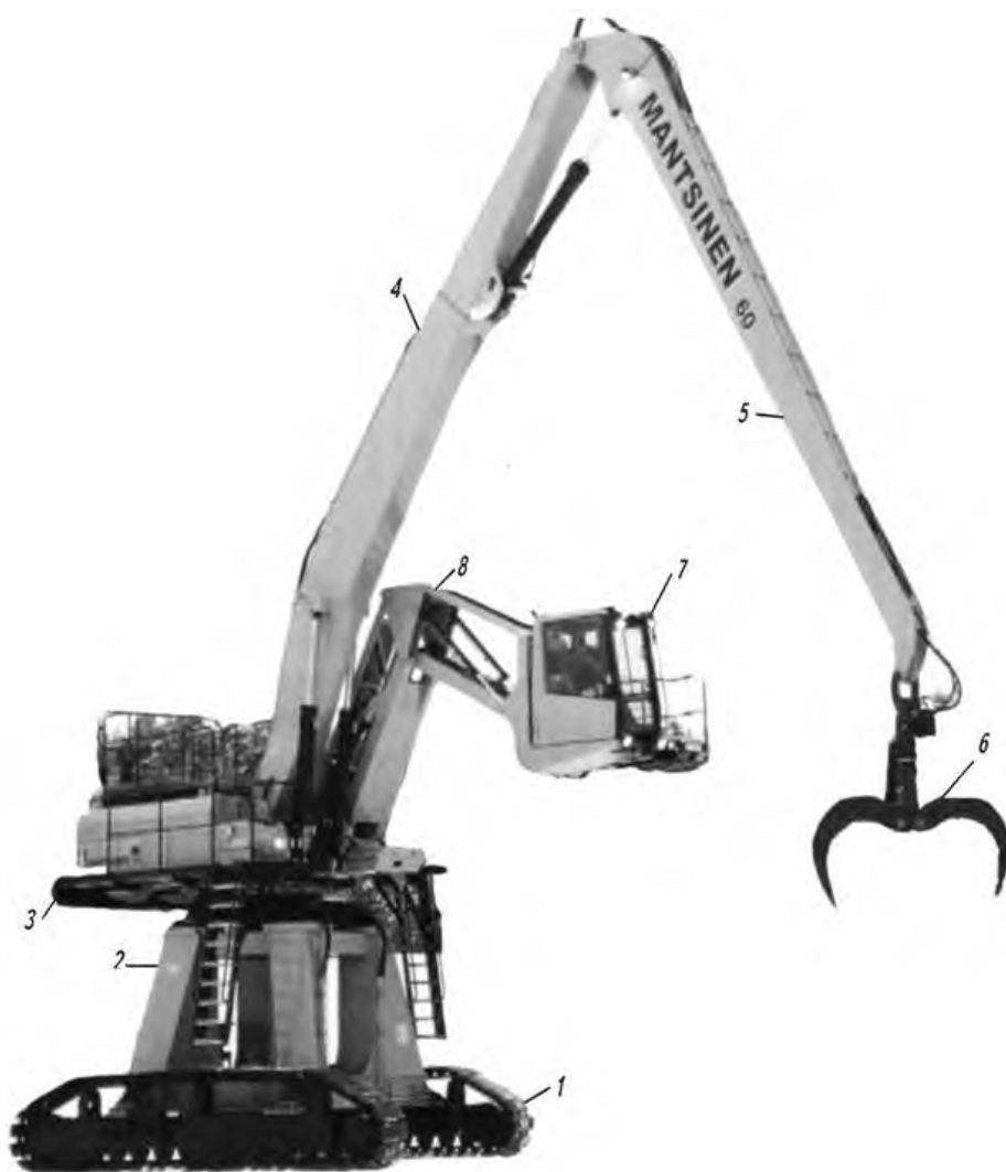
Рис. 5.4. Лесопогрузчик MSK-60 фирмы «Мантсинен» на базе универсального экскаватора фирмы «Хитачи»:
