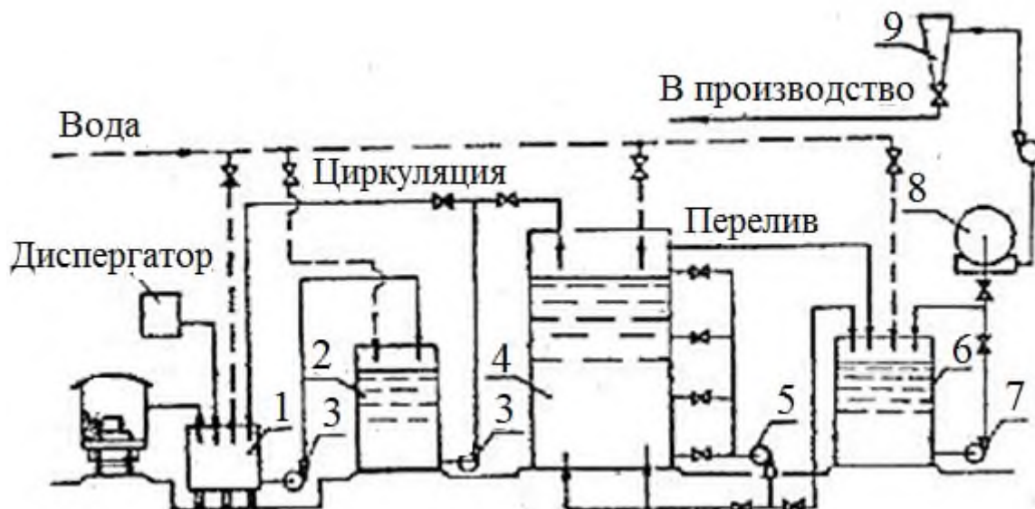
Рис.4.7. Схема склада хранения каолина в виде суспензии: 1 – гидроразбиватель; 2 – циркуляционная емкость; 3,5,7 – насосы; 4 – емкость-хранилище; 6 – мешальный бассейн; 8 – барабанный фильтр; 9 - очиститель
