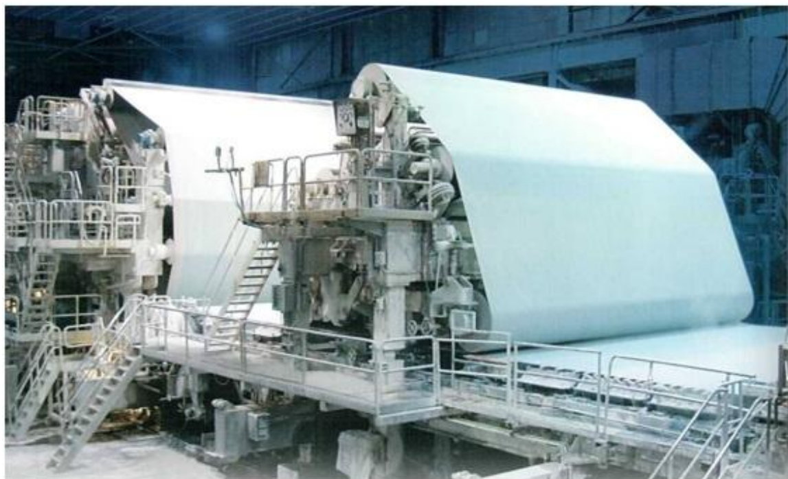
Рис.3. Сеточная часть с плоским столом и верхним формующим устройством для выработки мелованных бумаг
