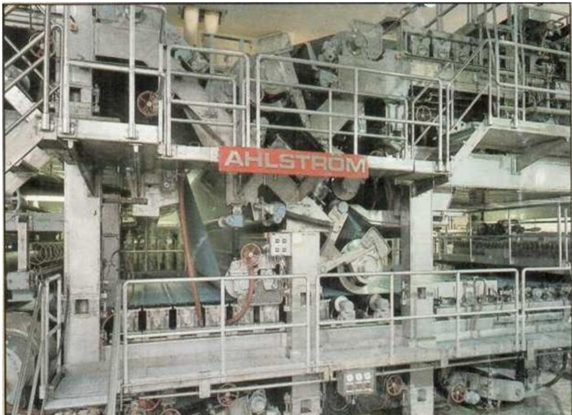
Рис. 5. Фрагмент сеточной части с тремя плоскими сеточными столами для выработки многослойной продукции
