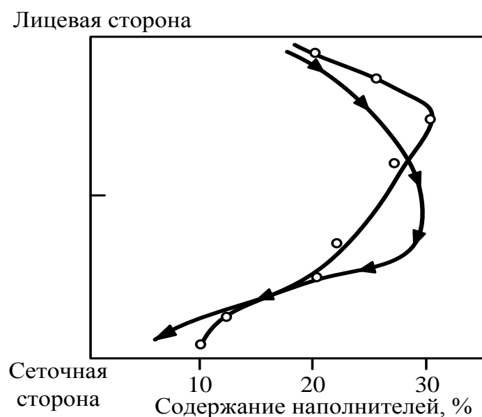
Рис.18. Влияние промывки полотна в области сухой линии на распределение наполнителей
