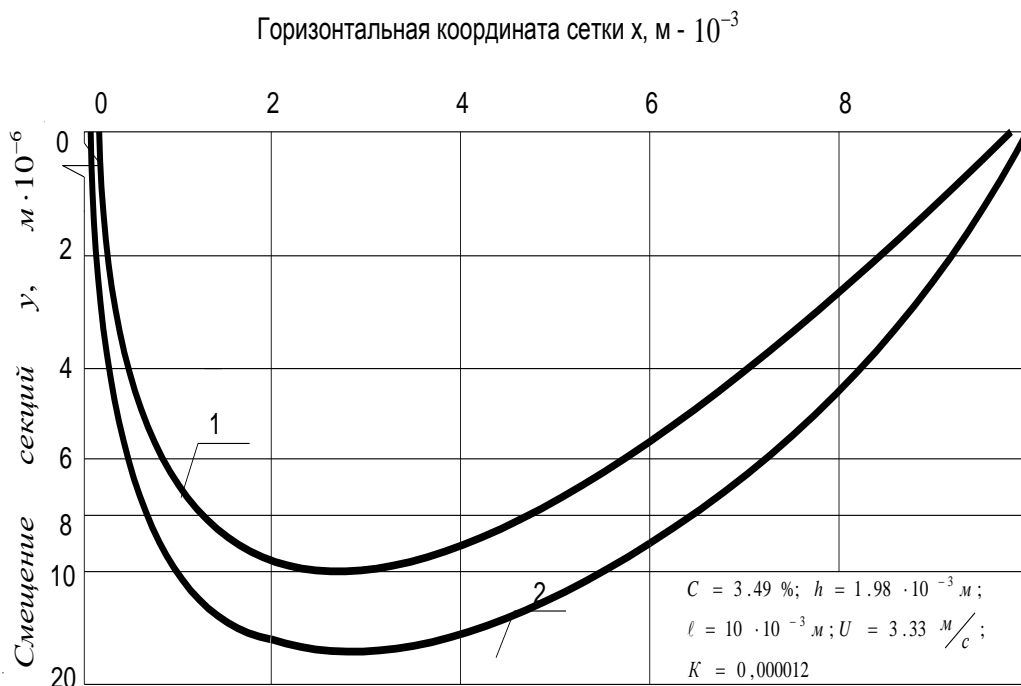
Рис.10. Влияние коэффициента фильтрации бумажной массы на профиль смещения сетки
