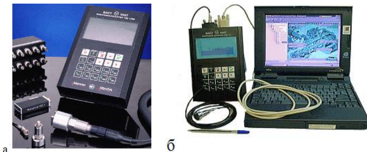
Рис. 4.18. Использование анализатора СД-12М а – внешний вид анализатора, б – измерительный комплекс на его базе
