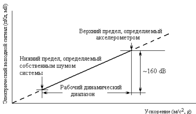
Рис.4.12. Динамический диапазон акселерометра
