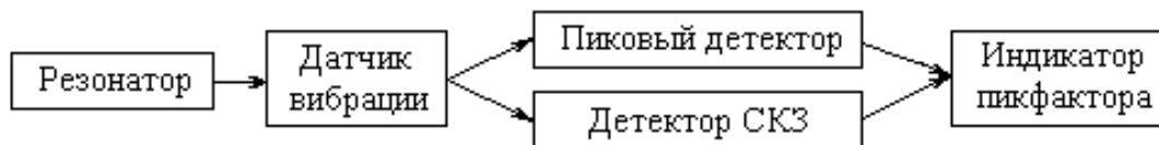
Рис. 3.5. Структурная схема прибора для измерения пик-фактора сигнала вибрации
