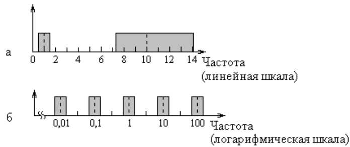
Рис.3.14. Амплитудно-частотные характеристики идеальных фильтров с постоянными относительными значениями ширины полосы пропускания
