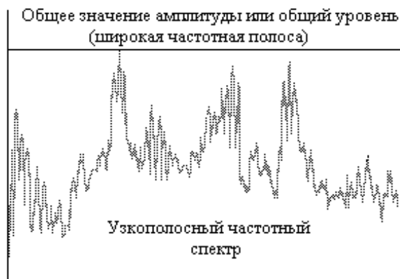
Рис.3.1. Общее значение амплитуды или общий уровень колебаний в широкой частотной полосе [4]
