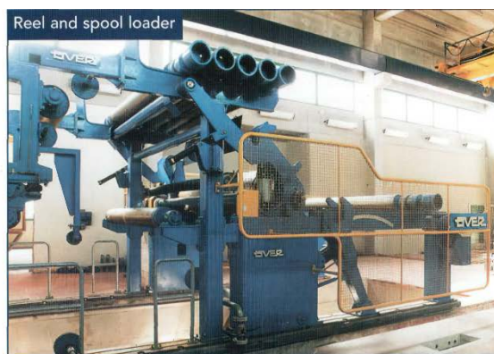
Рис. 92. Накат периферический фирмы «Over», Италия
