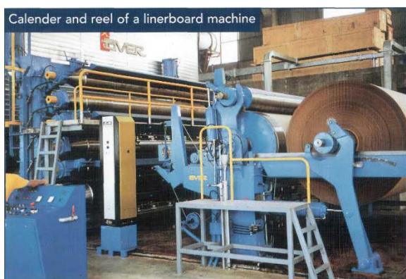
Рис. 92. Накат периферический фирмы «Over», Италия
