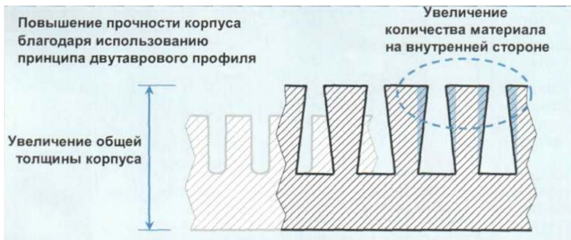
Рис. 76. Конфигурация внутренней поверхности цилиндра для выработки санитарно-гигиенической бумаги
