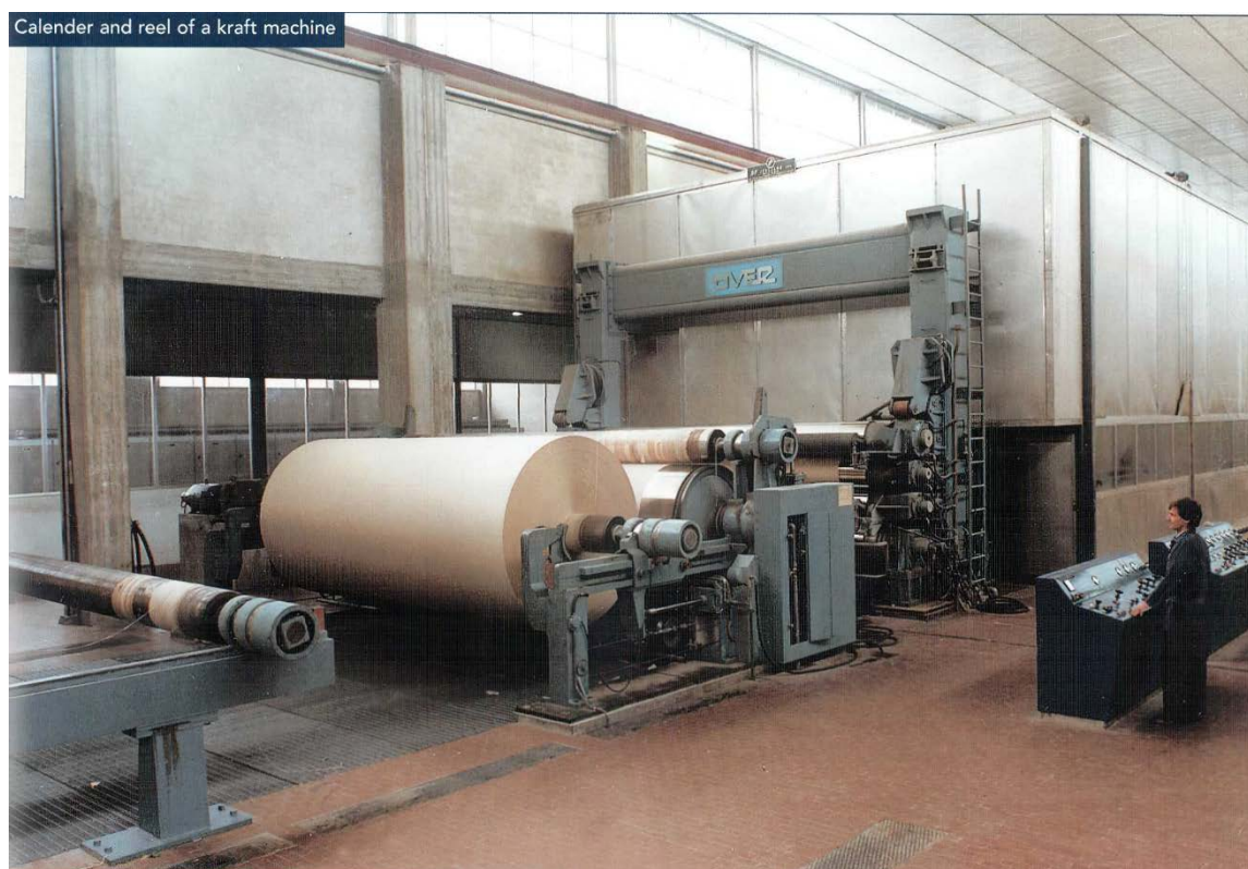
Рис. 83. Четырёххвальный машинный каландр фирмы «Over», Италия
