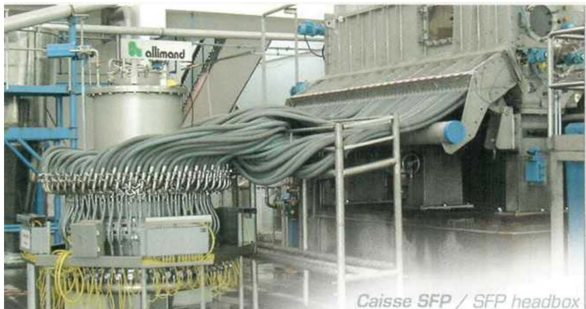
Рис. 11. Напорный ящик с выносным гасителем пульсаций («кастрюля») с встроенным в него потокораспределителем, наличием воздушной подушки, с системой разбавления и подачи суспензии в корпус напускного устройства. Фирма «Allimand», Франция
