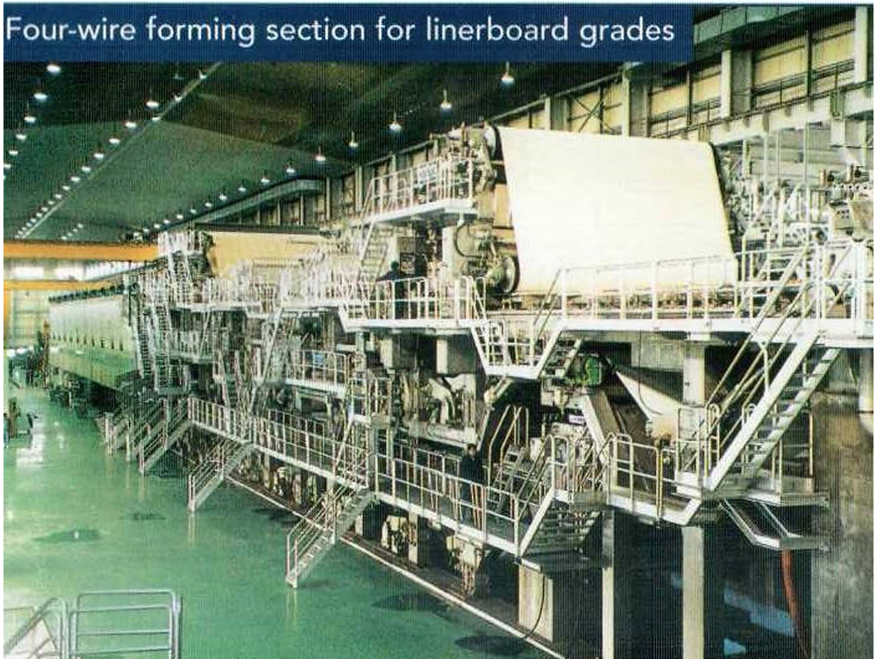
Рис. 3. Картоноделательная машина для выработки многослойного картона фирмы «Over-mecanik», Италия
