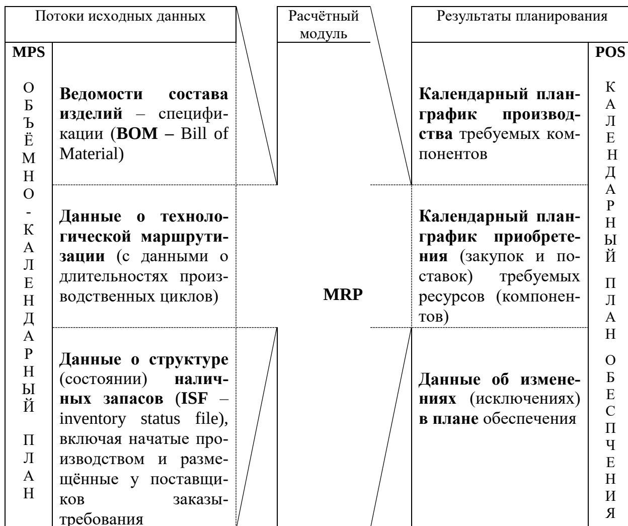
Рис. 2.16. Принципиальная схема планирования потребности в материальных ресурсах в системе стандарта MRP
