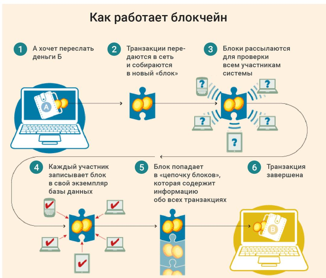
Рисунок 1. Схема работы технологии блокчейн
