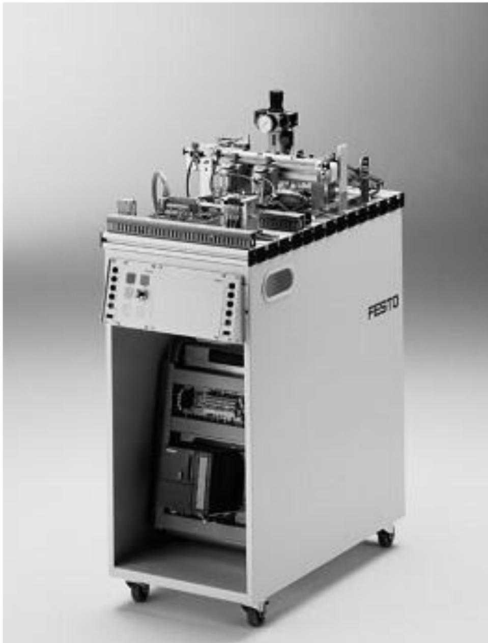
Рис.1.1. Сортировочная станция с консолью управления
