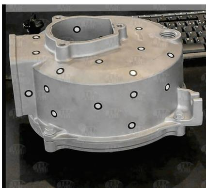
Рис. 2.3. Деталь, подготовленная маркерами (матированная) для 3D-сканирования [26]
