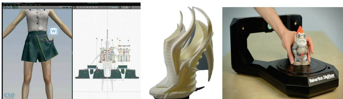
Рис. 1.8. Использование технологии 3D-сканирования и печати в дизайне одежды, обуви и в создании моделей статуэток
