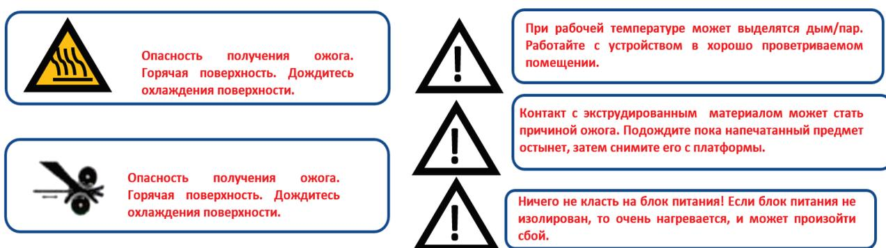
Рис. 3.2. Техника безопасности при работе с 3D-принтером MegaBot Dual Kit
