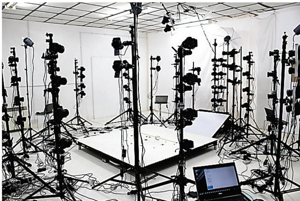
Рис. 2.9. Система камер и освещения для создания 3D-модели по принципу фотограмметрии
