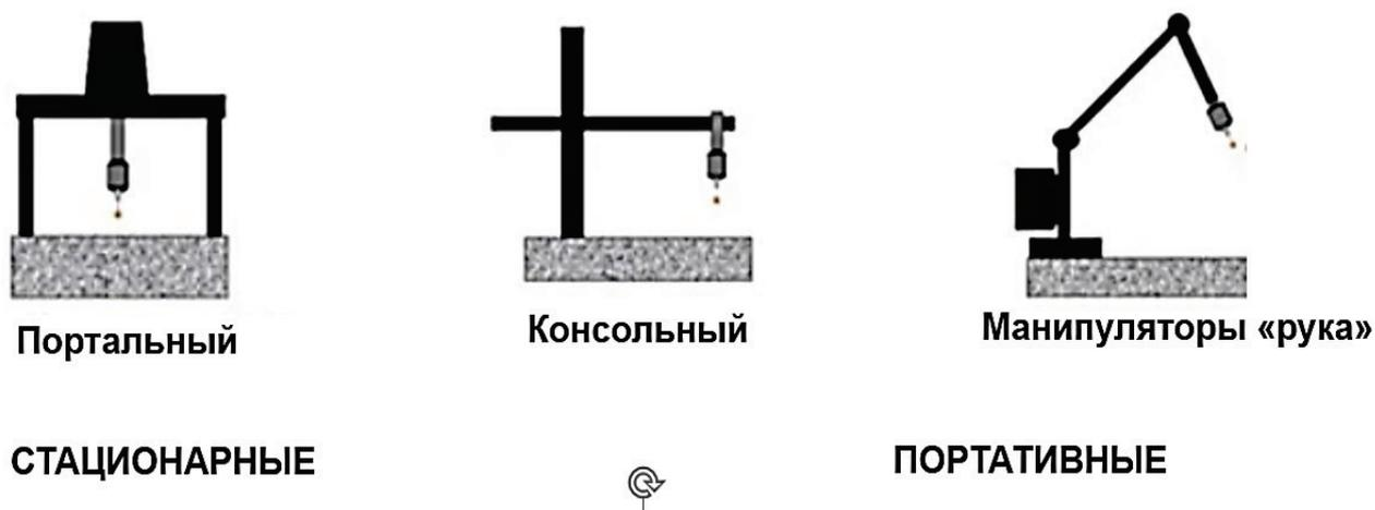
Рис. 2.4. Типы координатно-измерительных машин
