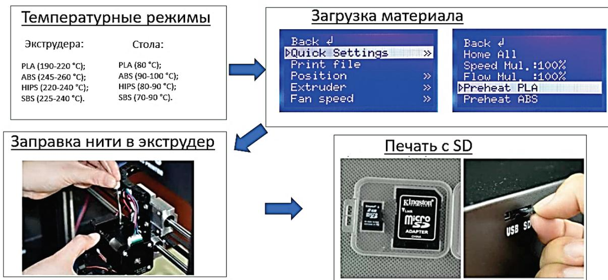
Рис. 3.18. Загрузка пластикового прутка в *Wanhao Duplicator i3*
