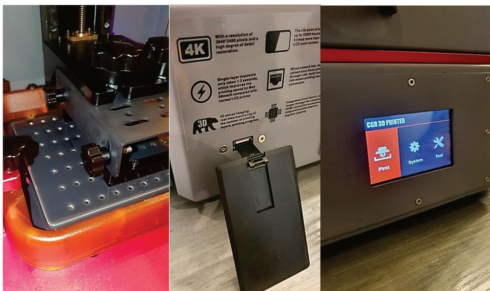
Рис. 3.60. Загрузка файла детали в программу 3D-принтера
