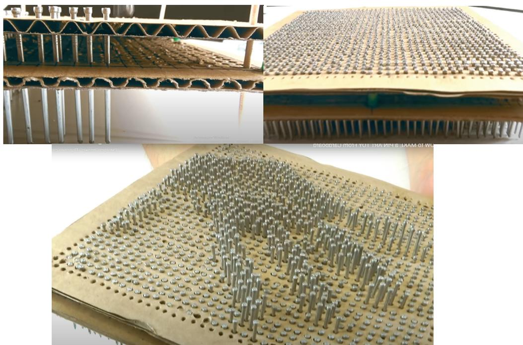
Рис. 2.1. Самодельный ручной сканер (контактный)
