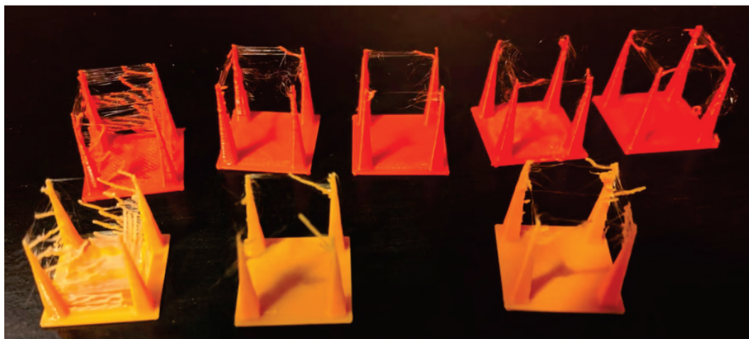
Рис. 36. Проблема образования нитей между выступами при неправильном режиме втягивания прутка пластика и с перебором подачи Retraction [8]
