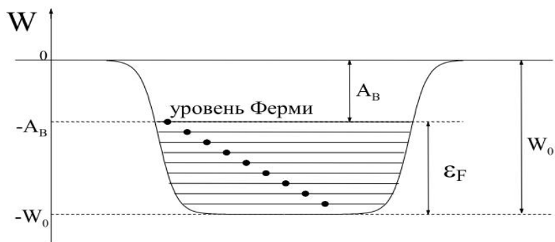
Рис. 10. Энергия электронов в металле. Уровень Ферми
