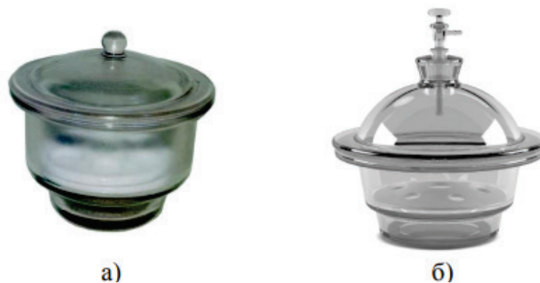
Рисунок 19 – Эксикатор: а) эксикатор без крана, б) эксикатор с краном для высушивания под вакуумом или в атмосфере инертного газа
