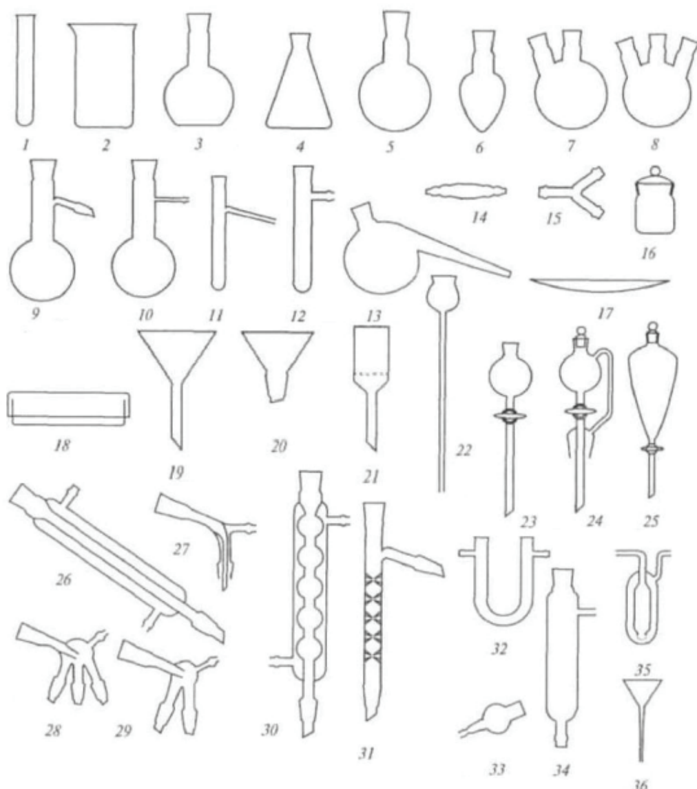
Рисунок 1 – Стекло́нная химическая посуда: 1 – пробирка; 2 – стакан химический; 3 – колба плоскодонная; 4 – колба коническая (Эрленмейера); 5 – колба круглодонная; 6 – колба Кляйзена; 7 – колба двугорлая; 8 – колба трехгорлая; 9, 10 – колбы Вюрца; 11, 12 – пробирки Вюрца; 13 – реторта; 14 – переходник; 15 – тройник; 16 – бюкс; 17 – часовое стекло; 18 – чашка Петри; 19 – воронка химическая; 20 – воронка для сыпучих веществ; 21 – воронка со стеклянным фильтрующим дном; 22 – воронка длинная; 23, 24 – капельные воронки; 25 – воронка делительная; 26 – холодильник Либиха; 27 – аллонж; 28, 29 – «пауки»; 30 – холодильник шариковый; 31 – дефлегматор; 32 – U-образная трубка; 33 – хлоркальциевая трубка; 34 – колонка осушительная; 35 – промывалка Мюнке; 36 – воронка Мюнке
