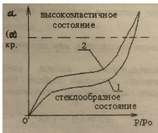
Рис. 1. Сорбция паров жидкости полимером с плотной (1) и рыхлой (2) упаковкой макромолекул одного и того же состава
