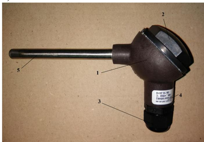
Рис.19. Внешний вид электрических термометров сопротивления
