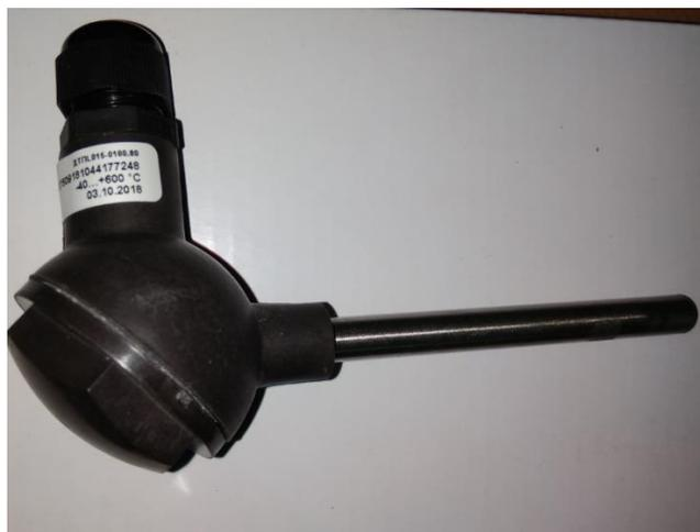
Рис.17. Внешний вид термопары ДТПЦ
