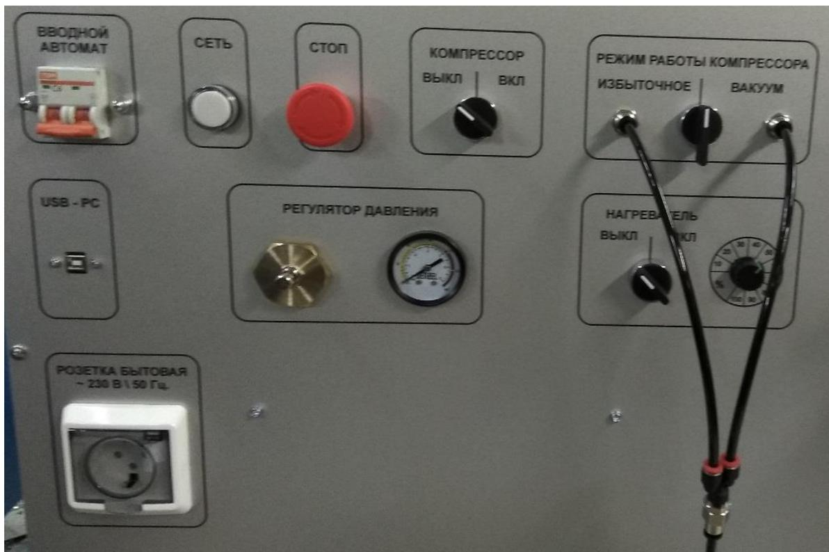
Рис.6. Органы управления и контроля приборной панели стенда
