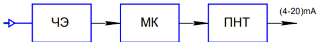
Рис. 14. Структурная схема датчика давления пьезорезистивного типа
