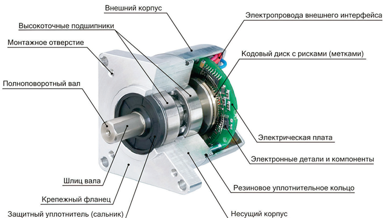
Рис. 5.5. Устройство инкрементального энкодера
