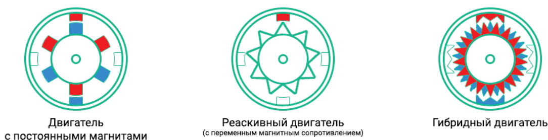
Рис.74. Шаговые двигатели с разными видами роторов
