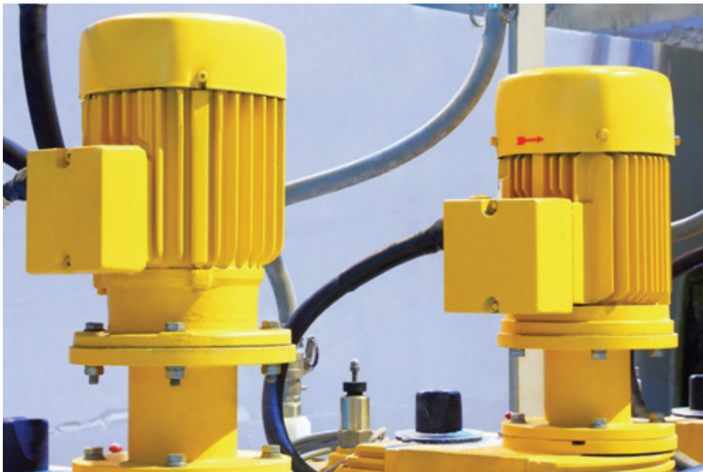
Рис. 23. Асинхронный двигатель с короткозамкнутым ротором
