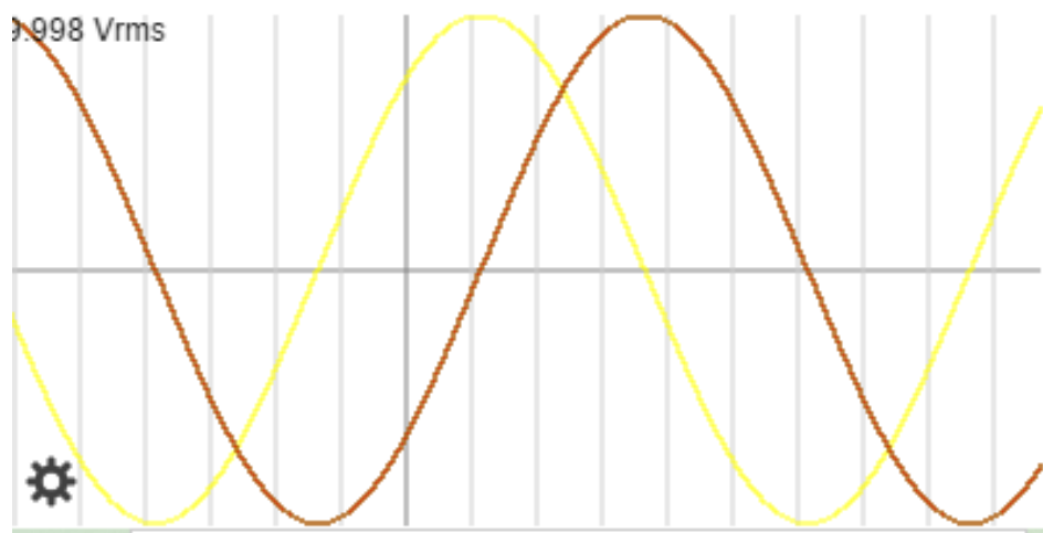
Рис. 2.9. Осциллограммы u_C(t) и i_C(t) при f = 50 Гц (пример х-варианта)
