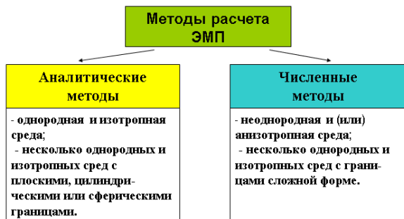
Рис. 11.4. Условия для применения аналитических и численных методов расчета ЭМП
