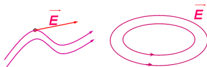
Рис. 1.1. Линии напряженности электрического поля
