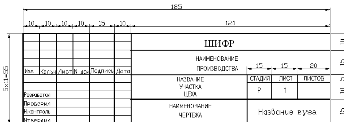
Рисунок 1 – Основная надпись для чертежей и схем ГОСТ 2.104-68 «Единая система конструкторской документации. Основные надписи»
