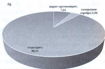
Рис. 4. Распределение серебра по основным минералам-носителям
