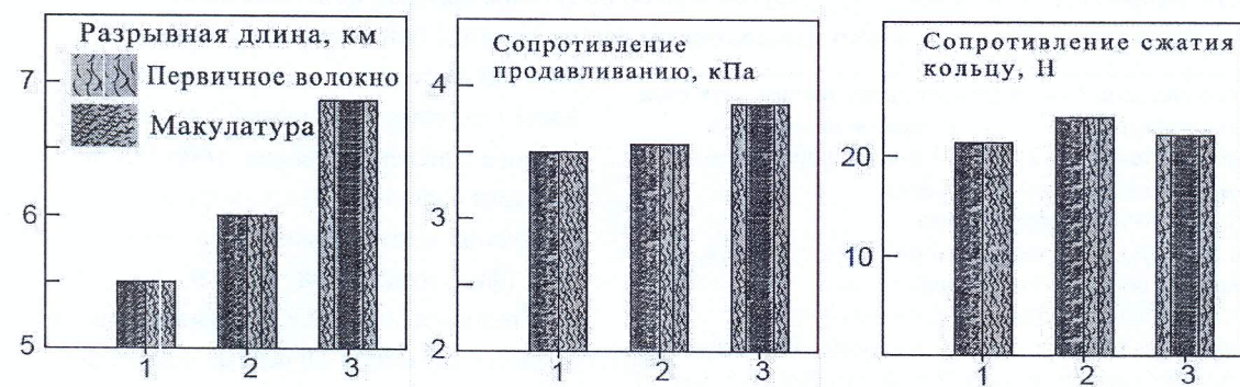
Рис. 2. Влияние расположения различных слоев на свойства картона
