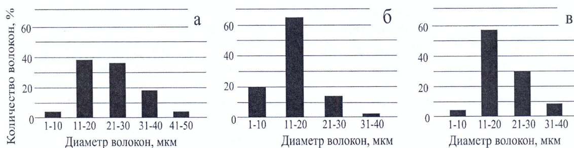
Рис. 3. Гистограммы распределения по поперечным размерам волокон ММ бумаги (а) и картона (б) после щелочной обработки и волокон ММ бумаги после гидролиза (в)
