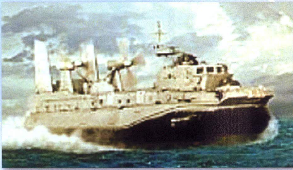
Рис. 17. Корабль на воздушной подушке «Омар» с газотурбинной энергоустановкой М34: Д – двигатель; PP – раздаточный редуктор; PBB – редуктор воздушного винта
