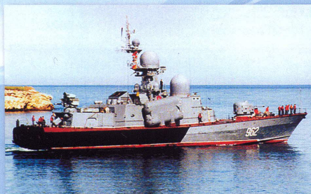
Рис. 9. Ракетный катер «Молния-1» с двумя газотурбинными установками М-15А Fig. 9. Molniya-1 guided missile boat with two M-15A gas turbines
