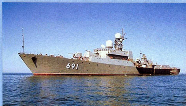
Рис. 13. Korvet «Gepard» s gazoturbinyan ustanovkoy M44 Fig. 13. Gepard corvette with M44 gas turbine
