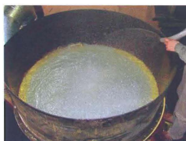
Рис. 17. Фотография пенного слоя при работе струйного фильтра
