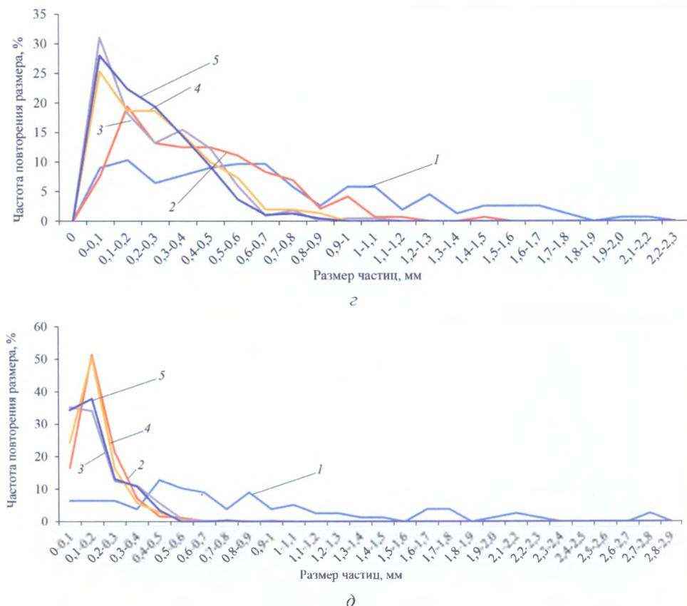
Рис. 7. Влияние продолжительности размола в лабораторной дисковой мельнице на размеры частиц (окончание): *а, б* – древесина ольхи и сосны соответственно; 1, 2, 3, 4, 5 – кривые распределения после 0, 1, 3, 5, 10 проходов через мельницу соответственно
