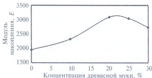
Рис. 6. Зависимость модуля накопления от содержания древесной муки в композиционном материале при 24 °С.
