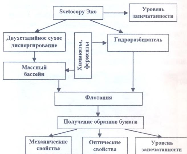
Рис. 4. Принципиальная схема очистки офисной макулатуры (в том числе с двухстадийным сухим диспергированием) и подачи ферментов отечественного производства.
