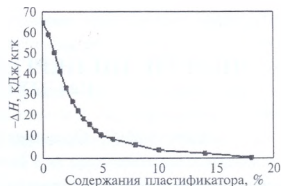
Зависимость интегральной энтальпии взаимодействия целлюлозы с водой от содержания пластификатора (водно-глицериновой смеси).
