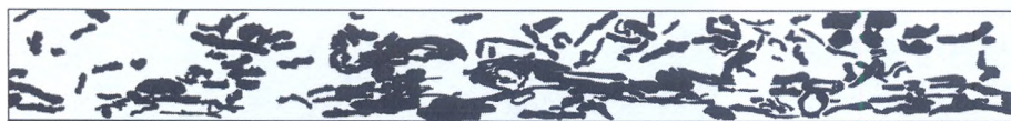
Рис. 4. Выделенные области среза волокнистого материала (в черном цвете) при работе с векторным форматом в программе AutoCAD
