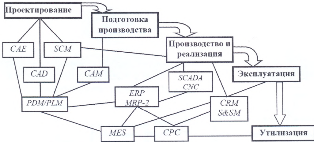
Рис. 2. Взаимоувязанные программные среды для построения системы сквозного электронного оборота на машиностроительном предприятии, где: CAE — Computer Aided Engineering (автоматизированные расчеты и анализ); CAD—Computer Aided Design (автоматизированное проектирование); CAM — Computer Aided Manufacturing (автоматизированная технологическая подготовка производства); PDM — Product Data Management (управление проектными данными); PLM — Product Lifecycle Management (управление жизненным циклом); SCM — Supply Chain Management (управление цепочками поставок); ERP — Enterprise Resource Planning (управление ресурсами предприятия); MRP-2 — Manufacturing (Material) Requirement Planning (управление ресурсами производства); MES — Manufacturing Execution System (производственная исполнительная система); CPC — Collaborative Product Commerce (совместный электронный бизнес); SCADA — Supervisory Control And Data Acquisition (сбор данных и диспетчерский контроль); CNC — Computer Numerical Control (управление технологическим оборудованием — ЧПУ); CRM — Customer Relationship Management (управление взаимоотношениями с заказчиками); S&SM — Sales and Service Management (управление продажами и обслуживанием)
