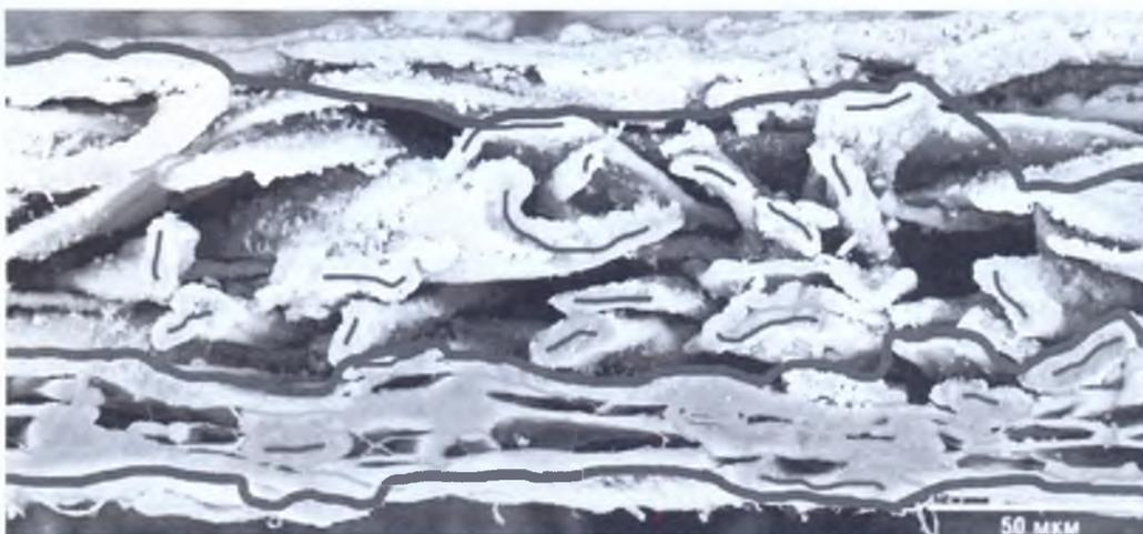
Рис. 2. Фрагмент изображения поперечного среза +2-хслойного тест-лайнера, выполненного методом ионной резки с дальнейшей обработкой графическими программами: **■** – профиль покровного слоя; **▬** – граница между покровным и нижним слоем; **▬** – профиль нижнего слоя; **▬** – линии контакта волокон; **▬** – линии контакта стенок волокон
