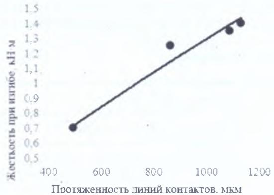
Рис. 7. Зависимость жесткости на изгиб от протяженности линий контактов волокон
