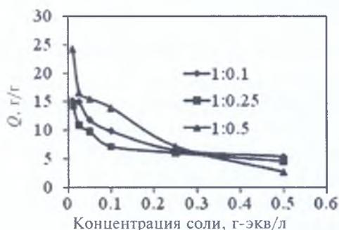
Рис. 7. Зависимость степени набухания полиамфолитных гидрогелей на основе этилендиамина с разным соотношением исходных компонентов от концентрации NaCl.
