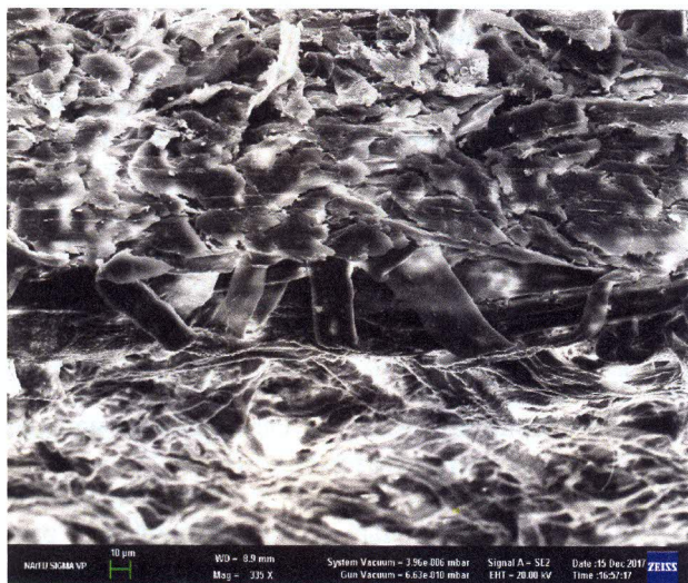
Рис. 1. Микроскопический снимок поперечного среза многослойного тест-лайнера: 1- область покрывного слоя; 2 — область границы двух слоёв; 3 — область нижнего бурого слоя
