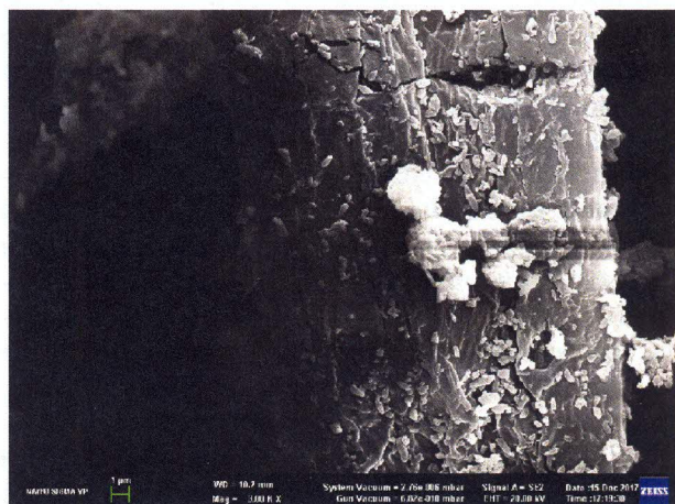
Рис. 2. Микроскопический снимок вторичных волокон с наличием участков деструкции: 1 — область деструкции волокон покрывного слоя тест-лайнера, полученного из макулатуры МС-7А; 2 — область деструкции волокна нижнего слоя тест-лайнера, полученного из макулатуры МС-5Б
