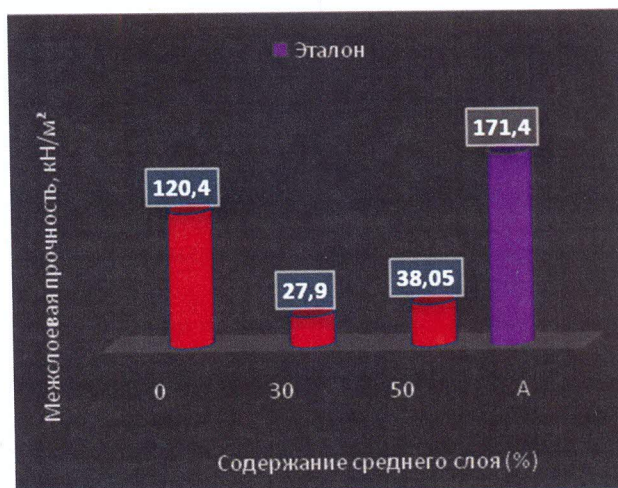
Рис. 4. Зависимость межслоевой прочности от содержания среднего слоя многослойного тест-лайнера: ■ — эталон (трёхслойный тест-лайнер, с добавкой первичных волокон, с фракционированием и размолом массы); ■ — формование с использованием макулатуры МС-8Б в среднем слое, без фракционирования и размола
