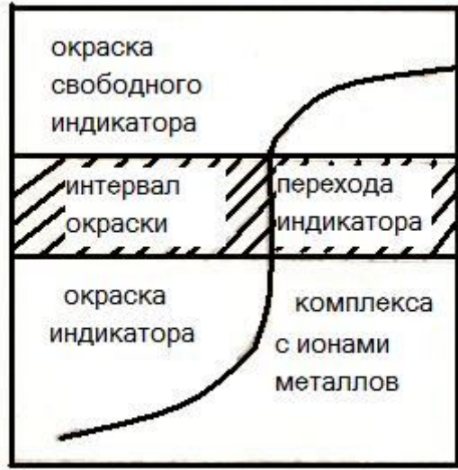
Рис. 7. Принцип действия металлоиндикатора
