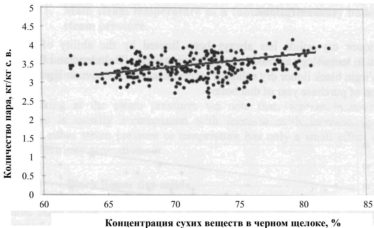
Рис. 10. Количество вырабатываемого пара в зависимости от концентрации сухих веществ в черном щелоке [21]
