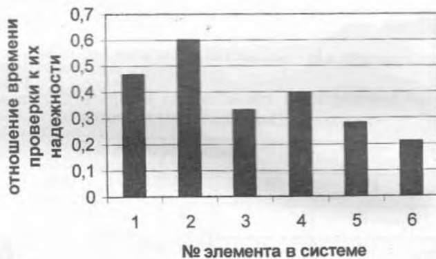
Рис. 7. Диаграмма оптимальной последовательности проведения испытаний элементов
