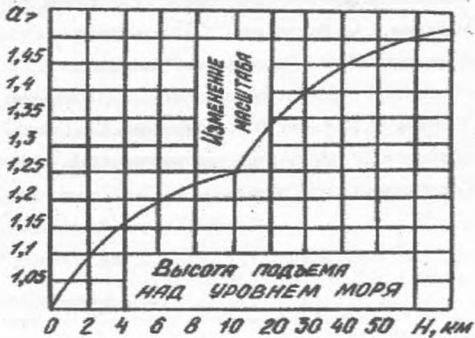
Рис. 6. Номограмма для определения коэффициента нагрузки по влиянию атмосферного давления
