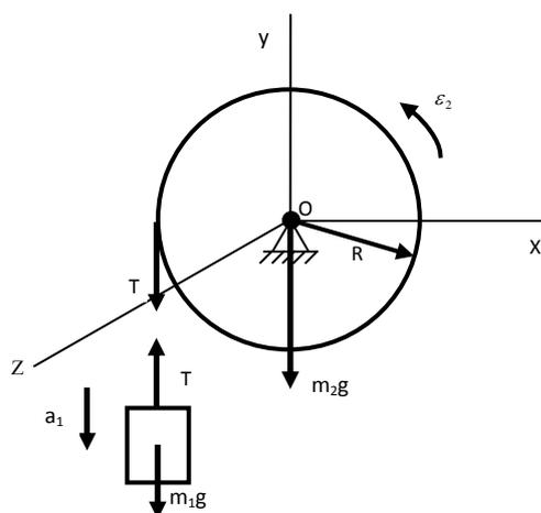
Тело 1 движется поступательно вдоль оси  $y$ . Силы, действующие на тело 1 – сила тяжести  $m_1g$  и сила натяжения нити  $T$ . Составим дифференциальное уравнение движения тела 1 в проекции на ось  $y$ :
