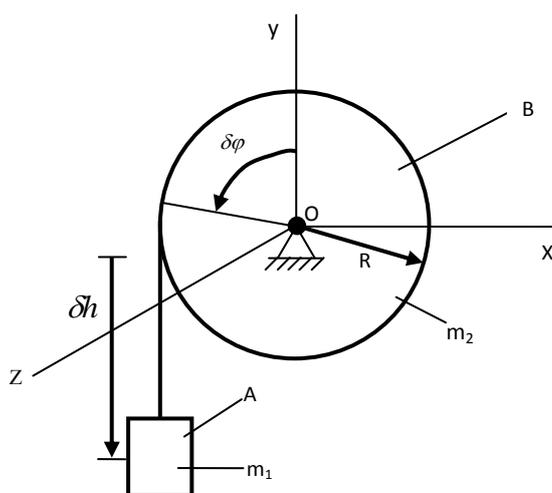
Механическая система состоит из двух тел: груза  $A$ , совершающего поступательное движение, и барабана  $B$ , совершающего вращательное движение.
