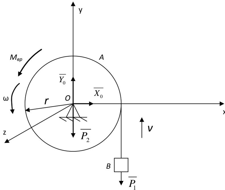
Рассматриваем систему, состоящую из барабана, лебедки, нити, груза. На систему действуют активные внешние силы:  $P_1=m_1g$ ,  $P_2=m_2g$  и реакции подшипников  $\overline{X}_0$ ,  $\overline{Y}_0$ .
