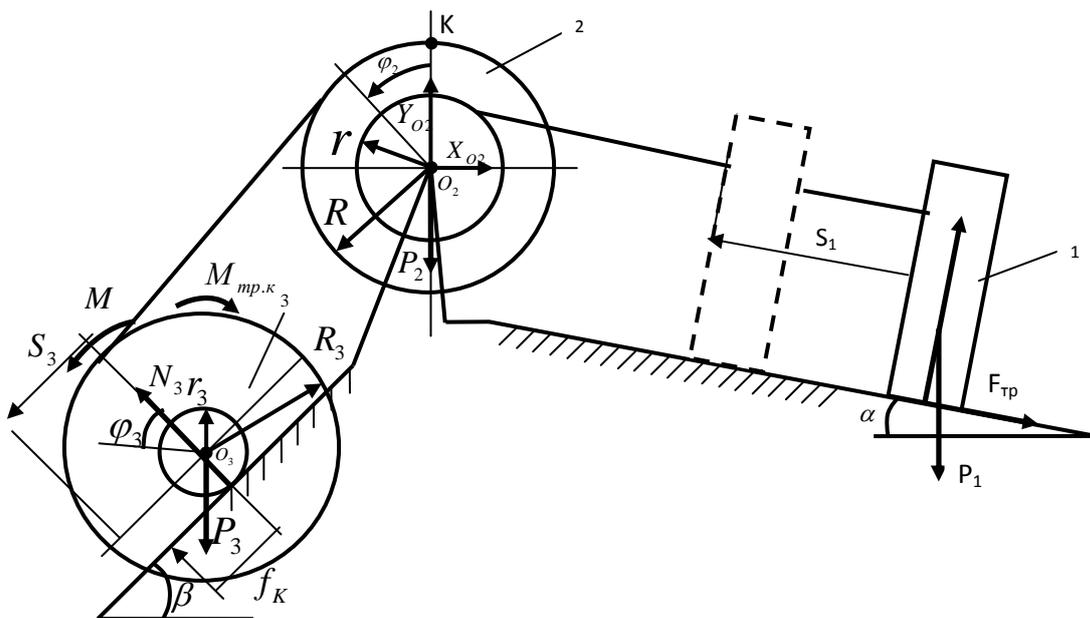
Рассмотрим механическую систему, состоящую из груза 1, движущегося поступательно, блока 2, совершающего вращательное движение и катка 3, совершающего плоское движение.
