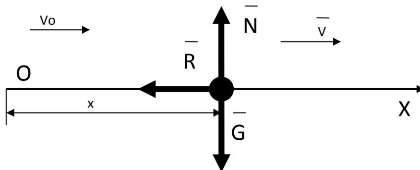
На точку действуют: сила тяжести  $G=mg$ , сила сопротивления  $R$  и нормальная реакция  $N$ . Дифференциальное уравнение движения точки в проекции на ось  $OX$  имеет вид:
