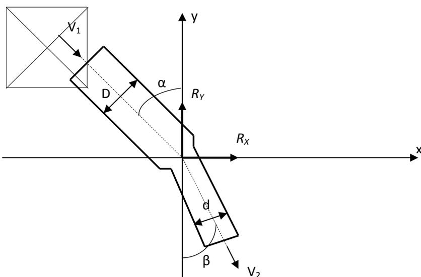
При установившемся движении масса жидкости, протекающей в единицу времени через любое сечение трубы, постоянна и равна:
